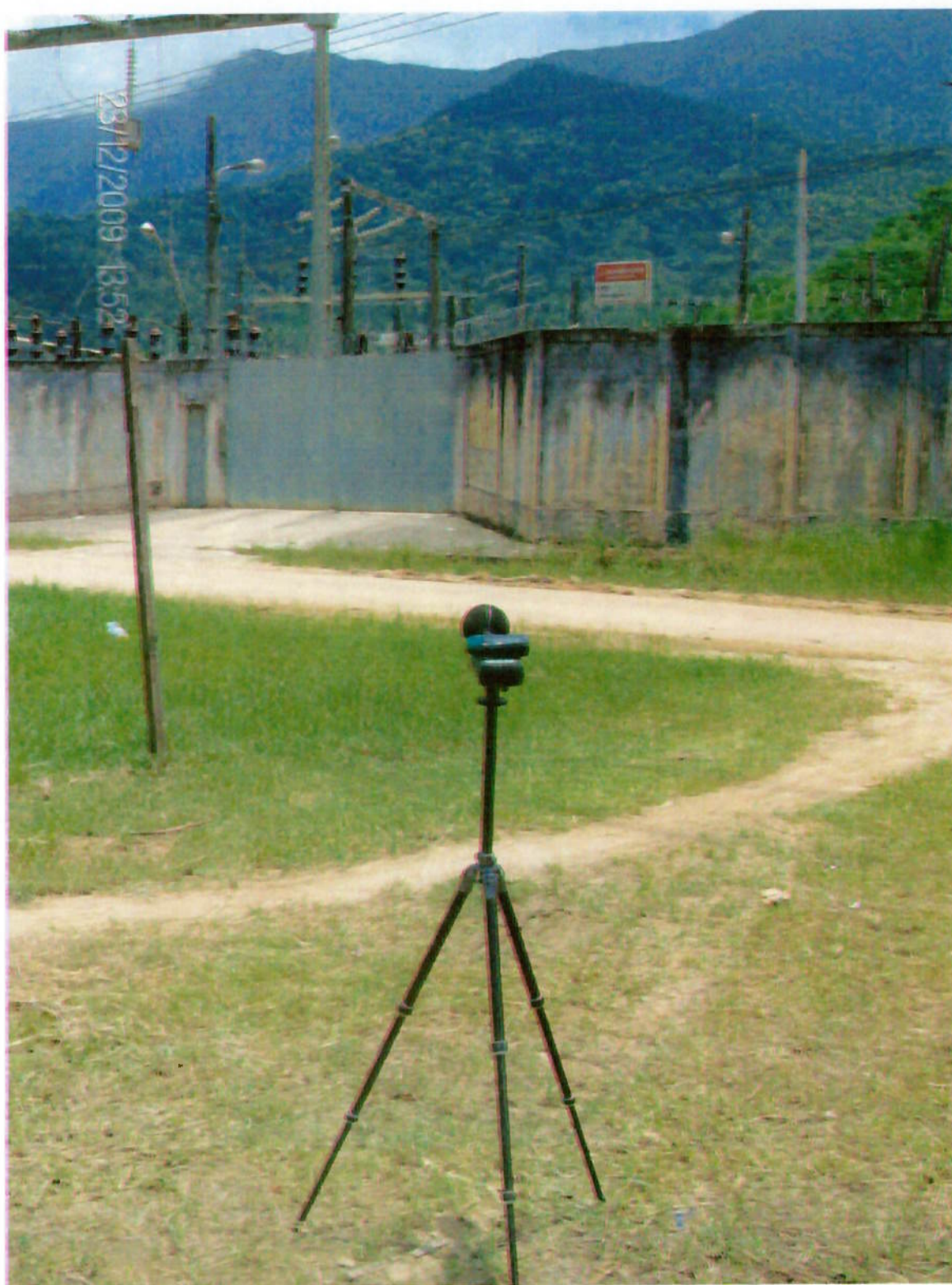
Figura 9 — Monitoramento de ruído externo à subestação defronte a residência (corpo receptor) vizinha à subestação, detalhe para a subestação ao fundo da foto.
