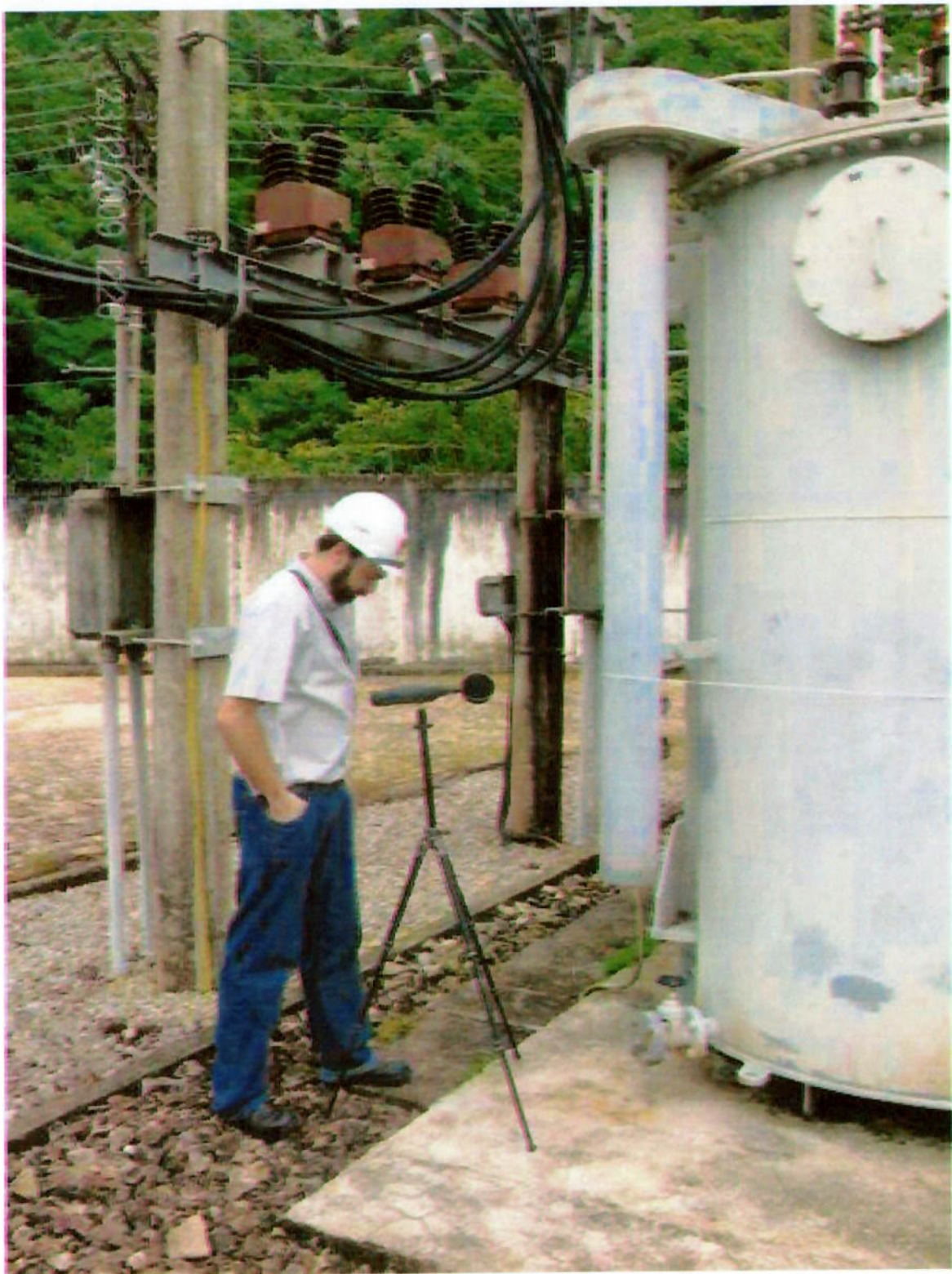
Figura 5 - Transformador em fase de monitoramento de ruído com o sistema de arrefecimento desligado.
