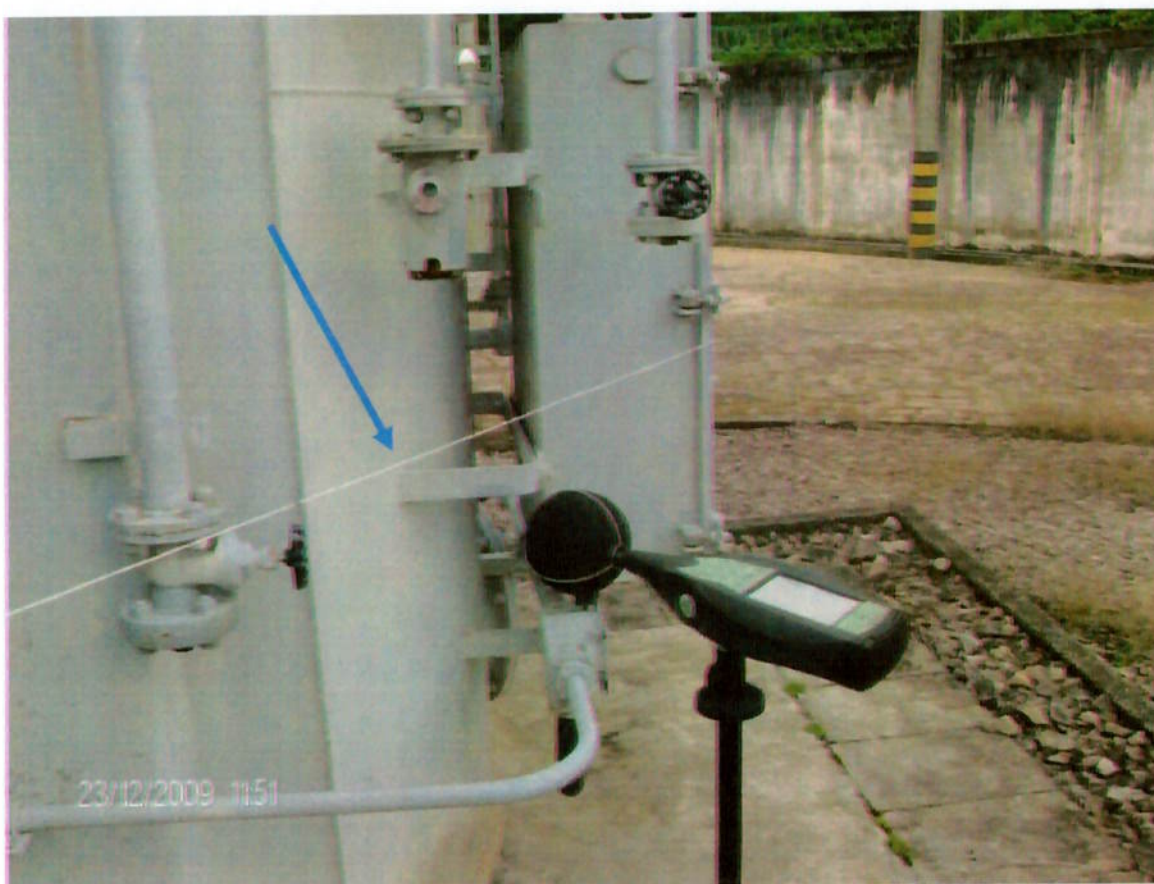
Figura 6 - Detalhe da corda no entorno do tanque do transformador, indicada com a seta azul e o equipamento de medição de ruído em operação.
