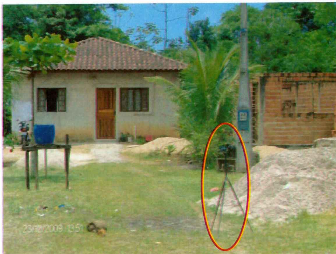
Figura 8 - Medição realizada na frente da residência localizada defronte à subestação, detalhe do medidor de ruído circundado em vermelho.
